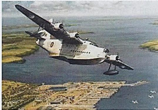
2. **Short SUNDERLAND MK.III** : construction britannique, 35 m d'envergure, quadrimoteur (4 Bristol Pegasus de 1000 chevaux), 9 à 11 hommes d'équipage, armement : 2 mitrailleuses de 12,7 mm, 10 mitrailleuses de 7,7 mm, bombes, grenades sous-marines
